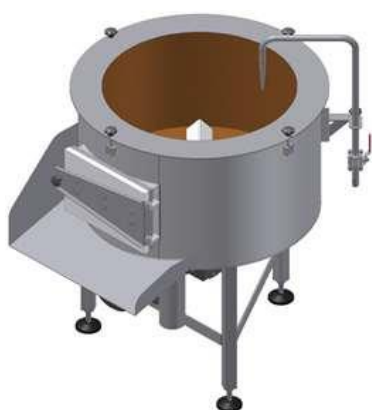
Rys. 4. Odłuszcarka bębnowa o osi pionowej z obrotowym dnem (opracowanie własne)
